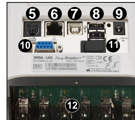
2. ábra: Az EasyReader+ analízátor hátlapja eltávolított alsó panel mellett
